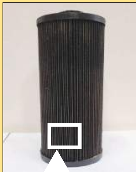
1年間ドラム缶またはポリ容器から 給油を行い続けた燃料フィルター
