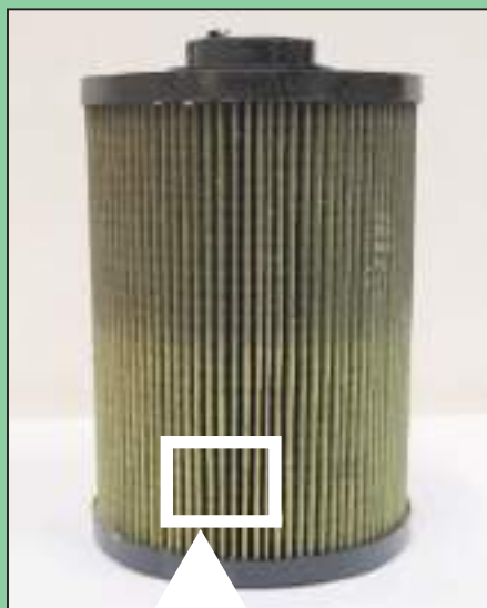
1年間弊社の燃料運搬容器のみで 給油を行った燃料フィルター
